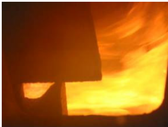
Joonis 7. Pilliroo ja hakkpuidu segu leek stokkerist väljumisel Figure 7. The flame of reed and wood chips mixture in outlet of stocker
