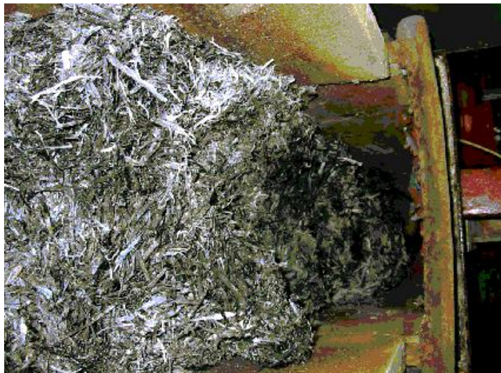
Joonis 5. Pilliroo põlemisel järele jääv tuhk Figure 5. Reed ash after combustion
