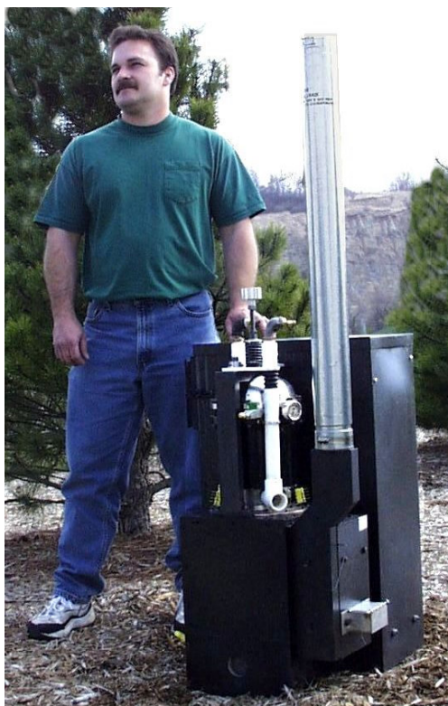
Joonis 2. Sunpoweri (USA) puidukiütel Stirlingmootor kodutarbeks
