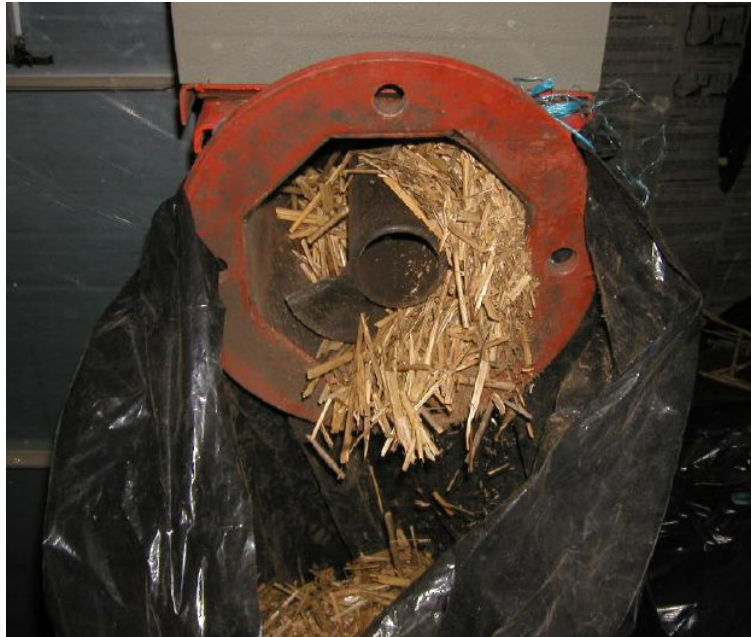
Joonis 2. Käsitsi peenestatud pilliroog tigüsööturist väljumal Figure 2. Hand-ground reed exiting from fuel feeding screw
